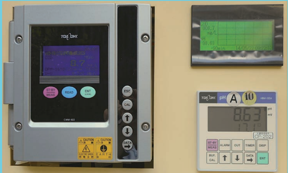
左は水質連続測定装置外観、右の表示器には連続監視データのグラフを表示されています。
